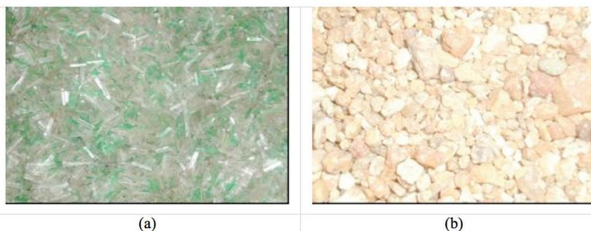
As garrafas PET trituradas foram adquiridas de recicladores, tendo os resíduos comprimentos variando de 0,6 a 0,9 milímetros (Figura 1a), enquanto o resíduo do peneiramento de areia lavada foi obtido de canteiros de obras da UFERSA em Mossoró-RN (Figura 1b), tendo como granulometria predominante a de 2,0 mm, conforme apresentado na Tabela 1.
