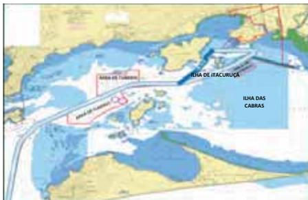
**DESCRIÇÃO:** Dragagem e derrocamento na área do Porto de Itaguai visando ao aprofundamento da cota de 14 m para 20 m e retificação do canal entre as ilhas das Cabras e de Itacuruca
