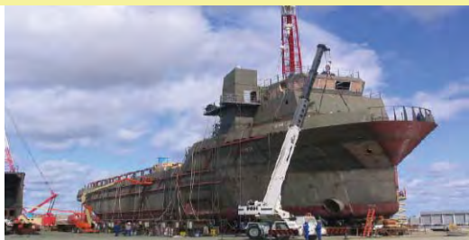
Fase final de construção de PSV – Estaleiro Navship/SC
